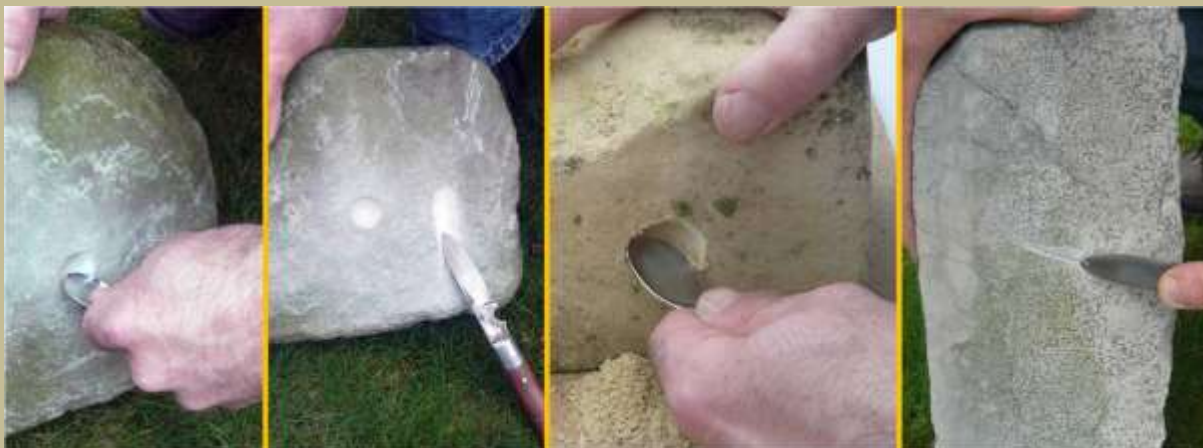
Experimenteren met het maken van krabsporen in Bentheimer zandsteen (foto 1+2), in kalksteen ('mergel', foto 3) en in kolenkalksteen (foto 4)
